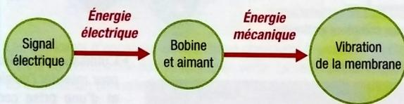
Lorsque la bobine est parcourue par un signal électrique correspondant à un son, elle déplace un aimant auquel la membrane en carton est reliée. L'énergie mécanique ainsi générée fait vibrer l'air et produit un son.
