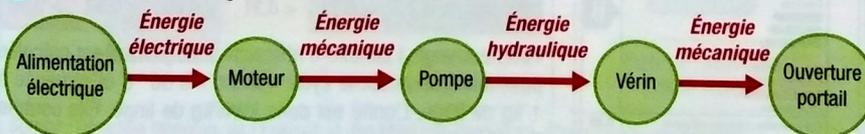
Le moteur électrique fournit l'énergie mécanique qui fait fonctionner la pompe hydraulique. Cette pompe met l'huile sous pression. L'énergie hydraulique ainsi créée est convertie (transformée) en énergie mécanique par le vérin qui ouvre ou ferme le portail.
